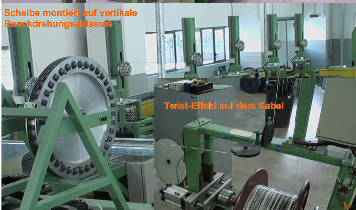
Scheibe mit vielfaeltigen Freiheitsgraden montiert auf einer SZ-Versellanlage
